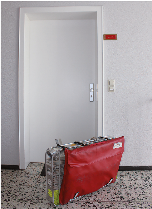
Bild 1.2 Beispiel für die schadenarme Einsatztaktik: Ein Mobiler Rauchverschluss wird am Schlauchtragekorb mitgeführt und kann so vor dem Eindringen in die Wohnung zur Verhinderung einer unkontrollierten Rauchausbreitung in den Treppenraum schnell montiert werden.
