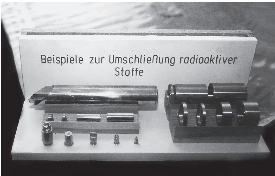
Die Kapsel muss so konstruiert sein, dass sie nur durch Zerstörung geöffnet werden kann.
