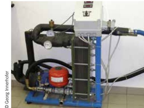
Typischer Plattenpasteurapparat zum Pasteurisieren von Fruchtsaft.
