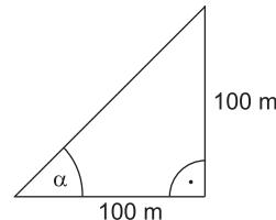
Bei einer Steigung von 84 % wird auf 100 m Länge eine Höhe von 84 m überwunden. Der Steigungswinkel beträgt:
