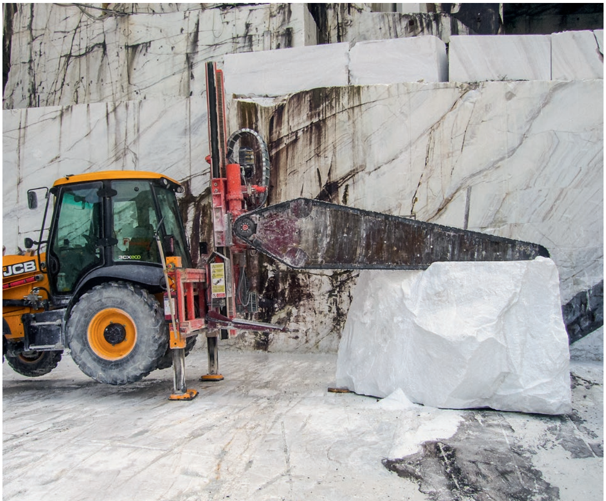
Abb. 7: Die Schneidetechnik mit Schwertsäge im Göflaner Marmorbruch. Das Sägeblatt ist mit Industriediamanten beschichtet. Foto: Wolfgang Platter
