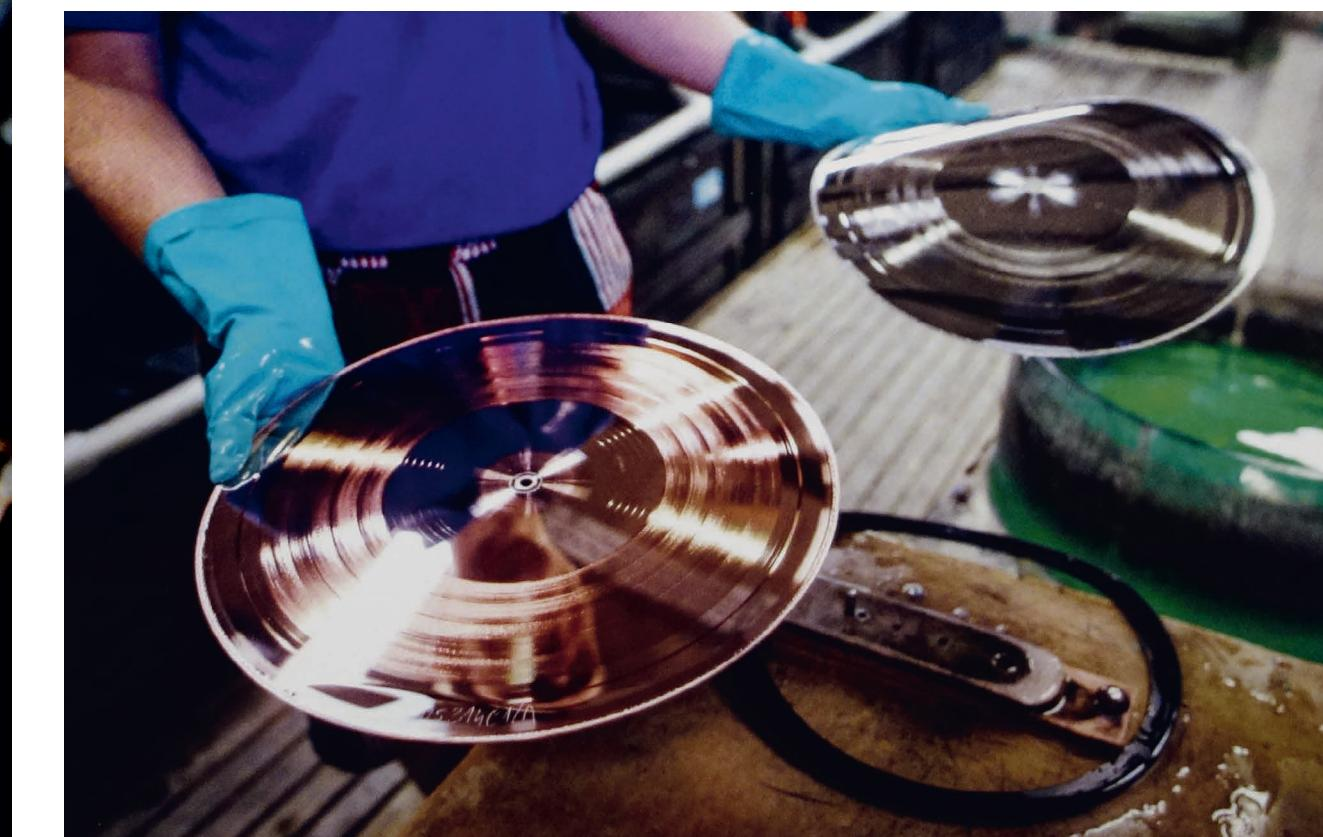
« Beim Direct Metal Mastering (DMM) wird die gemasterte Aufnahme mit einem Diamanten in eine mit Kupfer beschichtete Platte (die sog. Kupferfolie) geschnitten.
