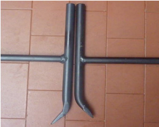
Bild 3: links: die altbekannte und fast »unverwüslliche« Ausführung Unterflurhydrantenschlüssel rechts: die kostenoptimierte Ausführung, mit der leider kein Hydrantendeckel angehoben werden kann. Und die Punktschweißung zwischen Querstange und senkrechter Stange hält mit Sicherheit keiner besonderen Belastung stand.
