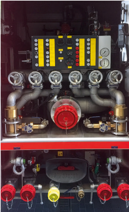
Bild 2: FPN 10/6000 in einem TLF 10 000, mit vier Tankfüllleitungen (jeweils mit freiem Einlauf) und einer Druckzumischanlage DIN EN 16327 – DZA 5000/0,1;1;3
