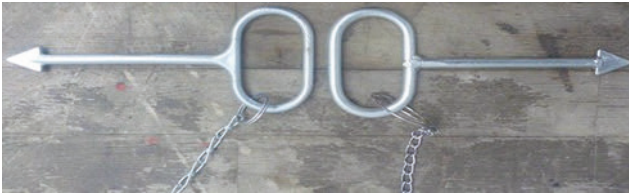
Bild 4: links: die bekannte, gesenkgeschmiedete Ausführung eines Schachthakens rechts: »kostenoptimiert« mit Punktschweißungen (andere, untenliegende Seite sogar ohne Punktschweißungen)
