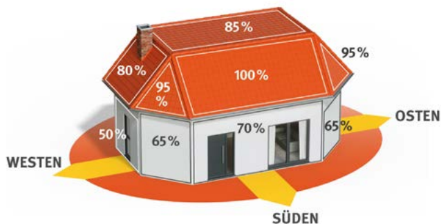
Abb. 4: Unterschiedliche Ausrichtungen der Module bringen unterschiedliche Erträge (auf 100 Prozent Maximalertrag bezogen).
