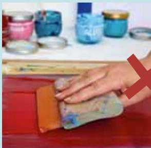
Hältst du die Rakel zu flach, läufst du Gefahr, dass zu viel Farbe in die offenen Bereiche des Siebes gelangt und Details im Druck verschwinden.
