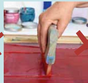
Wird die Rakel zu steil gehalten, drückst du mit der flachen Seite des Gummis. So kann es passieren, dass zu wenig Druck ausgeübt wird und zu viel Farbe durch die Maschen gelangt – das Motiv „vermatscht“.
