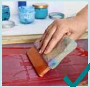
Halte die Rakel in einem Winkel von circa 45 Grad, während du sie mit Druck zu dir hinziehest. Auf diese Weise wird mit der Kante des Rakelgummis die Farbe durch die Maschen in das Textil gepresst.
