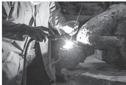
Löcher werden verschweisst oder verschraubt, Anschnitte des Giesssystems werden abgesägt.
