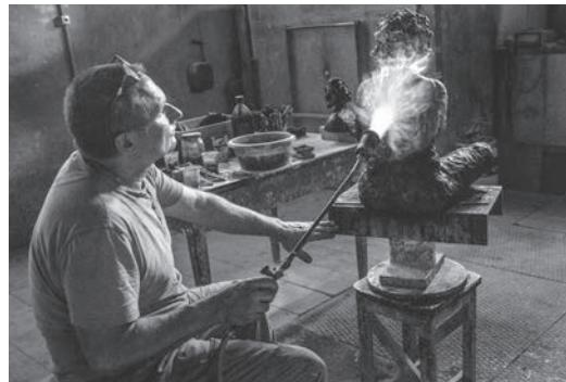
Die Farbe der Oberfläche wird durch einen Oxidationsprozess erzeugt.
