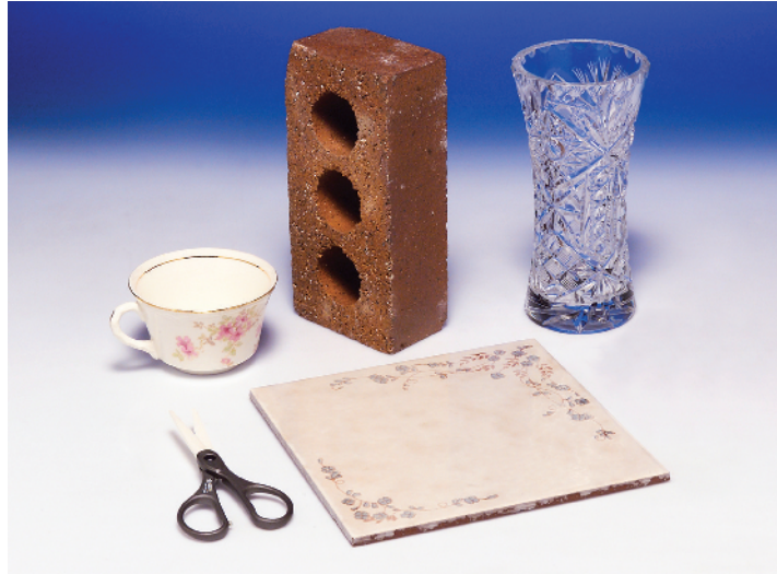
Abb. 1.9 Verschiedene Gebrauchsgegenstände aus Keramik und Glas: Schere, Teetasse, Ziegelstein, Keramikfliese und Glasvase.
