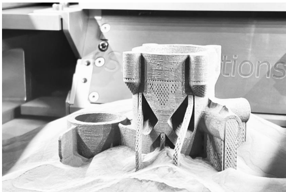
Abbildung 2: Mittels PBF-LB/M gefertigter Lenkungskäfig aus Ti-6Al-4V
