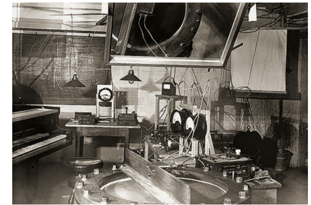
5 | Versuchsaufbau für Schwingungsmessungen an kreisförmigen Platten, um 1929, Firmenarchiv Grotrian-Steinweg © Grotrian-Steinweg, Braunschweig
