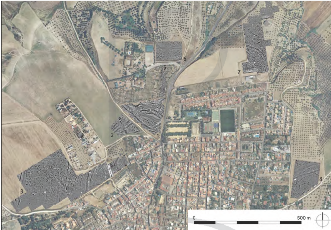
Abb. 4 Valencina de la Concepción. Magnetometerprospektionen 2014, 2017 und 2018. Digitales Orthophoto mit Magnetogrammen der Prospektionsareale 1–8. Dynamik \pm 8 nT, dargestellt in 256 Graustufen, 30-m-Gitter.
