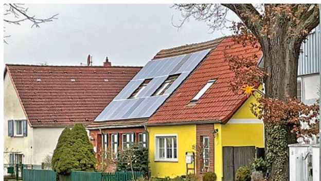
Negativbeispiel: Auch dunkle Module können sich durch Spiegelung stark von der Dachfläche abheben
