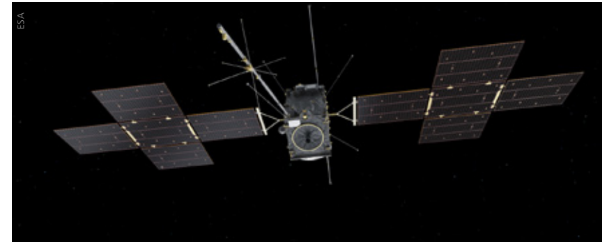
Einige der Antennen und Ausleger sind hier gut zu erkennen, nicht aber die Hoch- und Mittelgewinnantenne, denn die sind durch den Körper der Sonde verdeckt.
