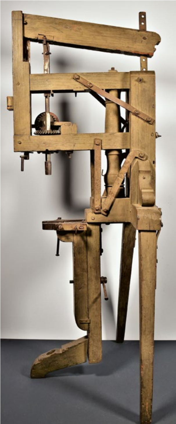
3 Feinbohrmaschine Chemnitz (?), Ende 18. Jahrhundert Kat. V.6
