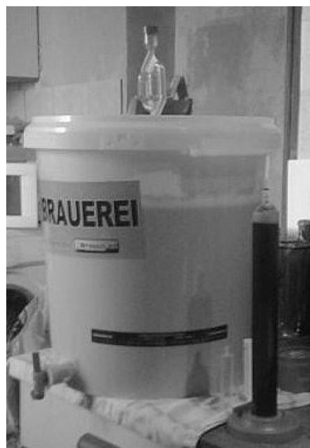
Gäreimer mit Gärröhrchen. Rechts davor ein Messzylinder mit Messspindel zum bestimmen der Stammwürze und des Vergärungsgrades.
