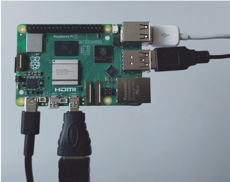
Abb. 1.8: RPi 5 mit angeschlossenen Geräten. Von links nach rechts: USB-C-Kabel zur Stromversorgung, Micro-HDMI-Adapter mit HDMI-Kabel, USB-Kabel von Tastatur und Maus
