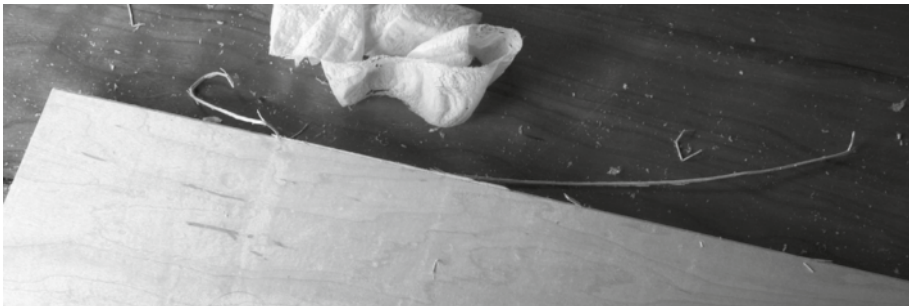
Foto 10: Auf Stärke aushobeln. Bei den letzten feinen Hobelstößen fällt der Riss des Streichmaßes vom Werkstück ab. Wenn man jetzt weiterhobelt, wird das Werkstück zu dünn.
