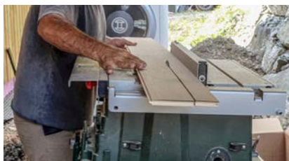
Auf der Tischkreissäge werden Bretter der Länge nach geschnitten, falls dies erforderlich ist.
