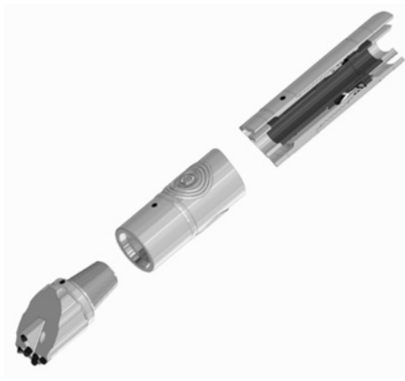
Bild 15. Aufbau einer asymmetrischen Bohrkronen
