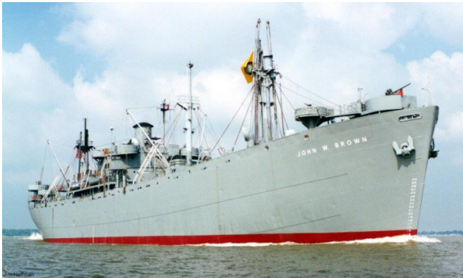
Bild 1.5 Ein Liberty-Schiff, das waren sehr rationell gefertigte Frachtschiffe für die Geleitzüge der Alliierten. Rund 2700 Stück wurden im 2. Weltkrieg von US-Schiffswerften gebaut [103].
