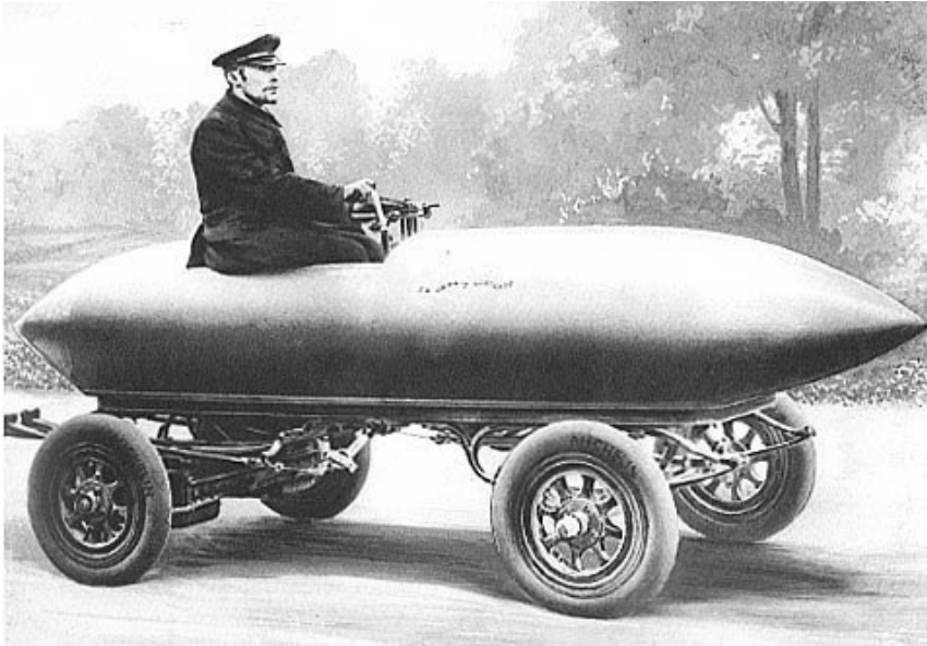
Bild 1.9 Der Elektrorennwagen La Jamais Contente fuhr bereits 1899 über 100 km/h.
