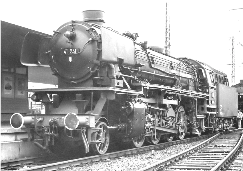
Bild 1.10 Eine deutsche Dampflokomotive 41241 im Essener Hauptbahnhof in den 1980er-Jahren [102]: Bei Dampflokomotiven beträgt der Wirkungsgrad nur etwa 10 %!
