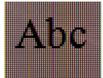
Abbildung 6.16: Eine stark vergrößerte Ansicht von Schrift auf einem Monitor, der aus Pixeln besteht. Da, wo der Text schwarz ist, leuchtet keines der Pixel, und würde man aus dem Bild herauszoomen, würde der Hintergrund der Schrift weiß erscheinen, weil alle Pixel mit allen Leuchtkörpern Rot, Grün und Blau gleichzeitig leuchten.
