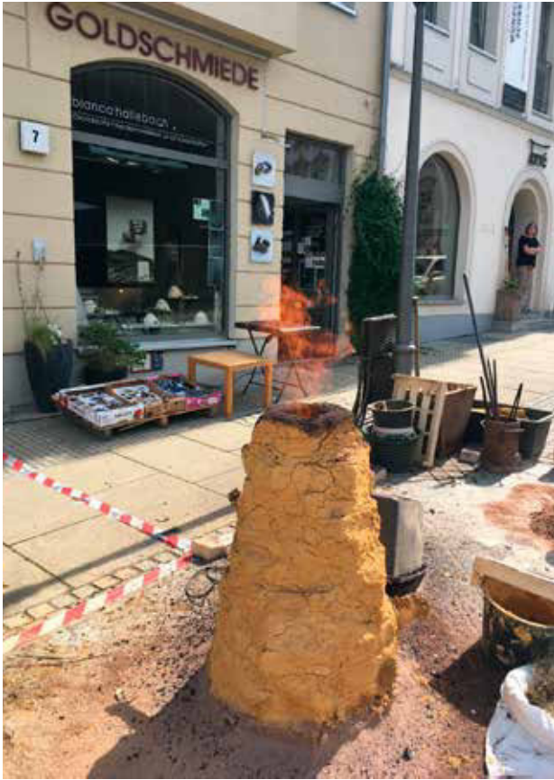
Abb. 4 In Betrieb befindlicher Rennofen zur Museumsnacht Plauen auf dem Altmarkt, 2022 (Foto: Bianca Hallebach).
