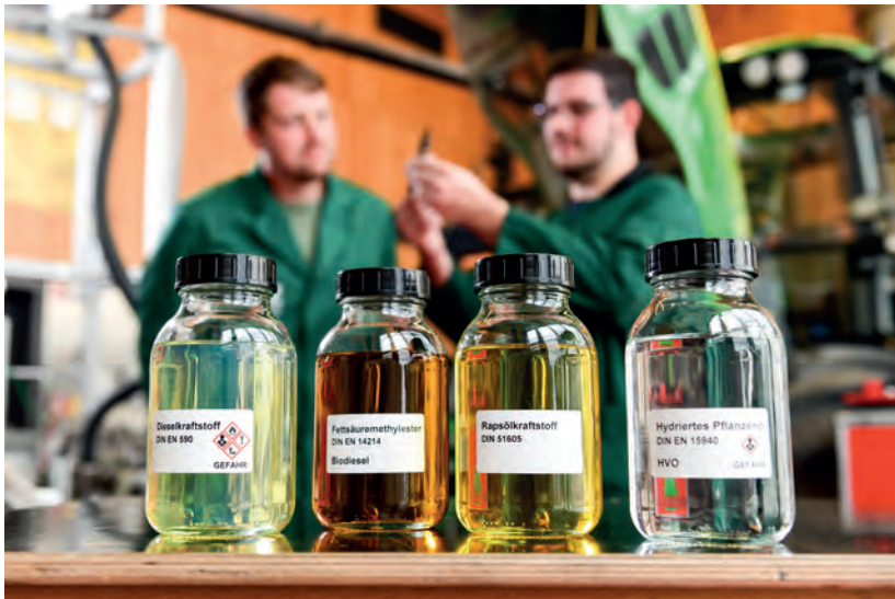
Bild: Diesel, Biodiesel, Rapsölmotorkraftstoff und Paraffinischer Diesel HVO für Leistungs- und Abgasmessungen am Traktorenprüfstand des Technologie- und Förderzentrums (Bild: Tobias Haase)
