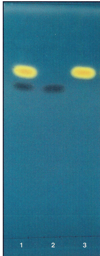
Abb. 2: DC von Beclometason-17,21-dipropionat auf einer Kieselgelplatte; Betrachtung nach Besprühen mit ethanolischer Schwefelsäure und Erhitzen unter UV 365
