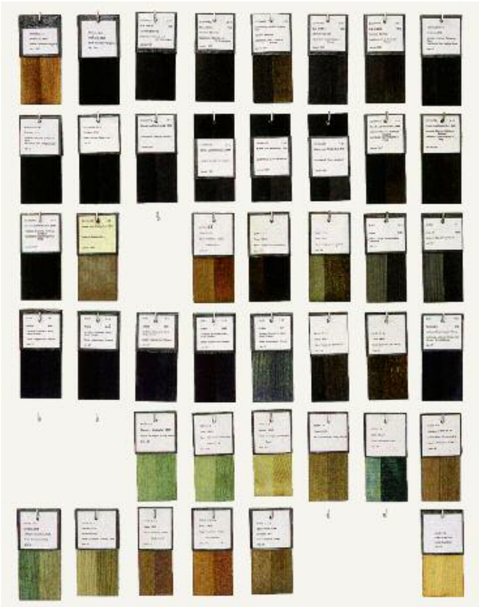
Abb. 543 Beizproben, die nach einseitiger Abdeckung und Lackierung der natürlichen Alterung und dem Tageslicht ausgesetzt werden (Ausführung: Studiengang Restaurierung, Fachhochschule Hildesheim, ab 1993).
