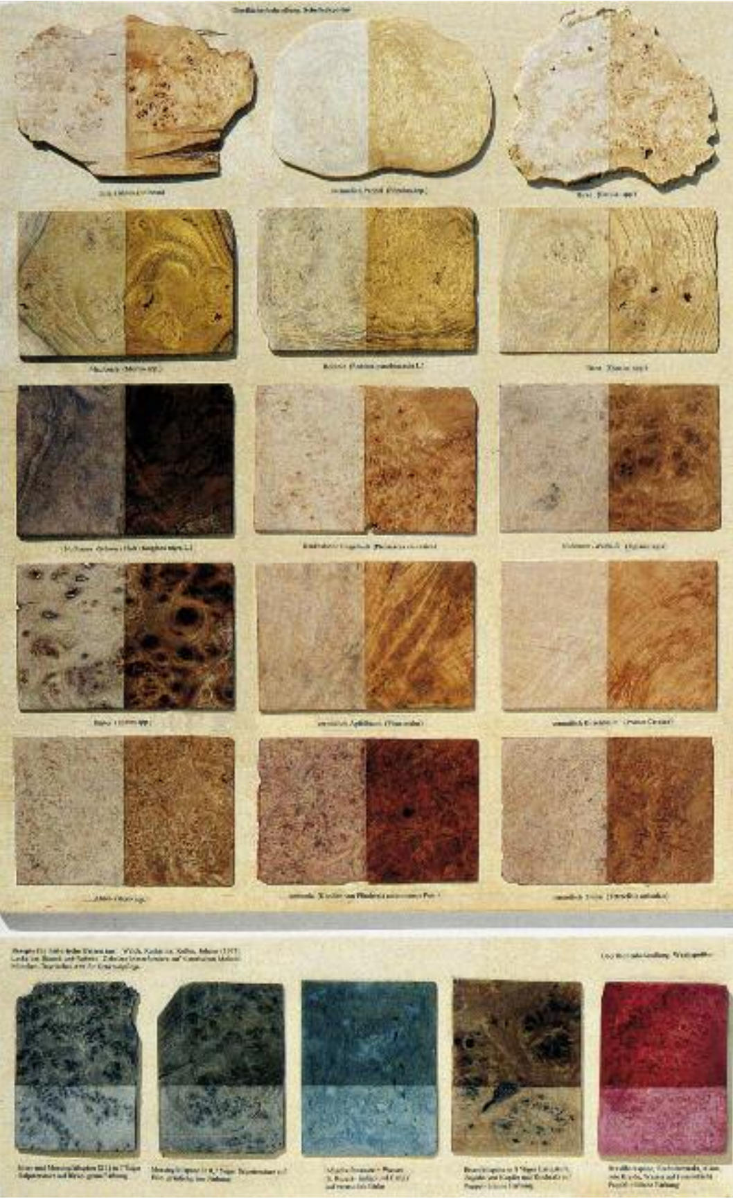
Abb. 226 Anschauungstafel mit verschiedenen Maserhölzern. Im unteren Teil mit Hilfe von Eisensalzen, Indigodisulfonsäure und Rotholz verschiedenfarbig eingebeizte Wurzelfurniere (Ausführung: U. Helbing, 2001).
