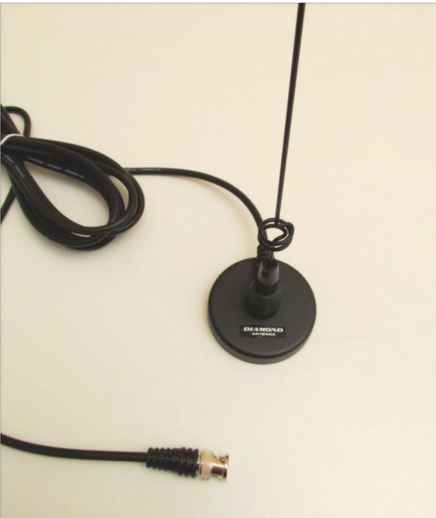
Abbildung 1.15 Mobilantenne für das 2-m- und 70-cm-Band
