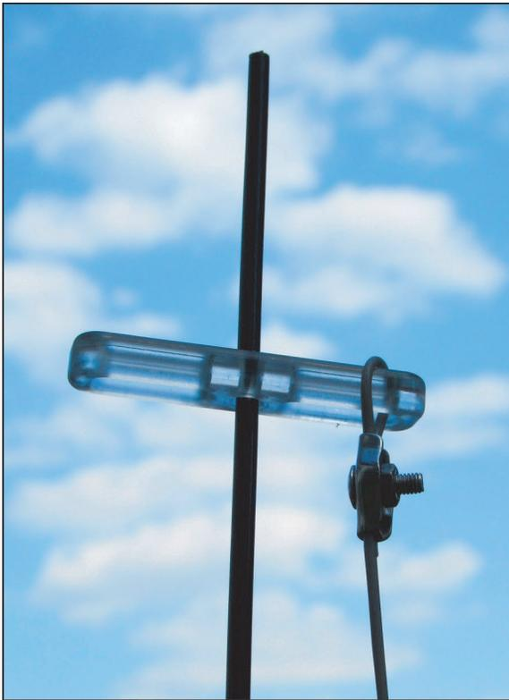
**Abbildung 32.30** Endisolator der HyEndFed auf der Spitze eines GFK-Mastes
