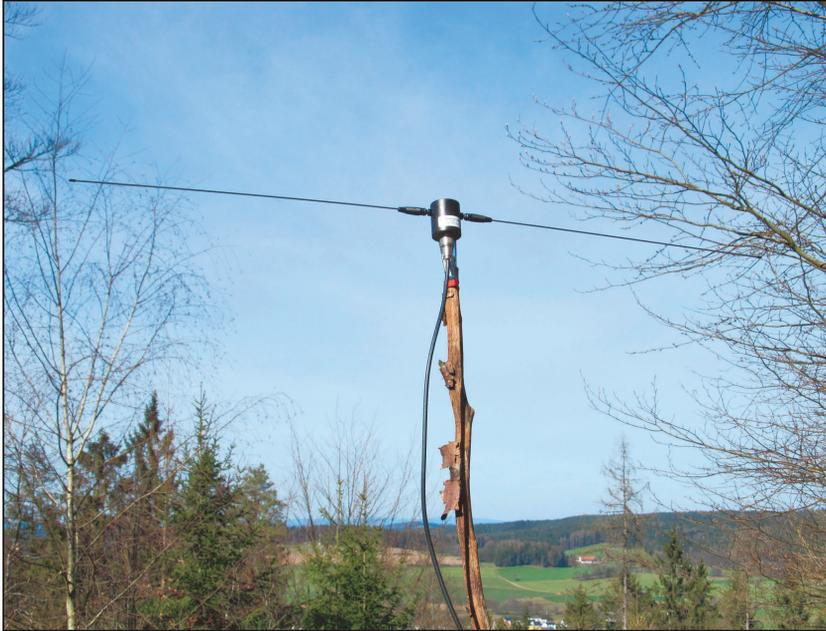
Abbildung 32.33 VHF/UHF-Dipol
