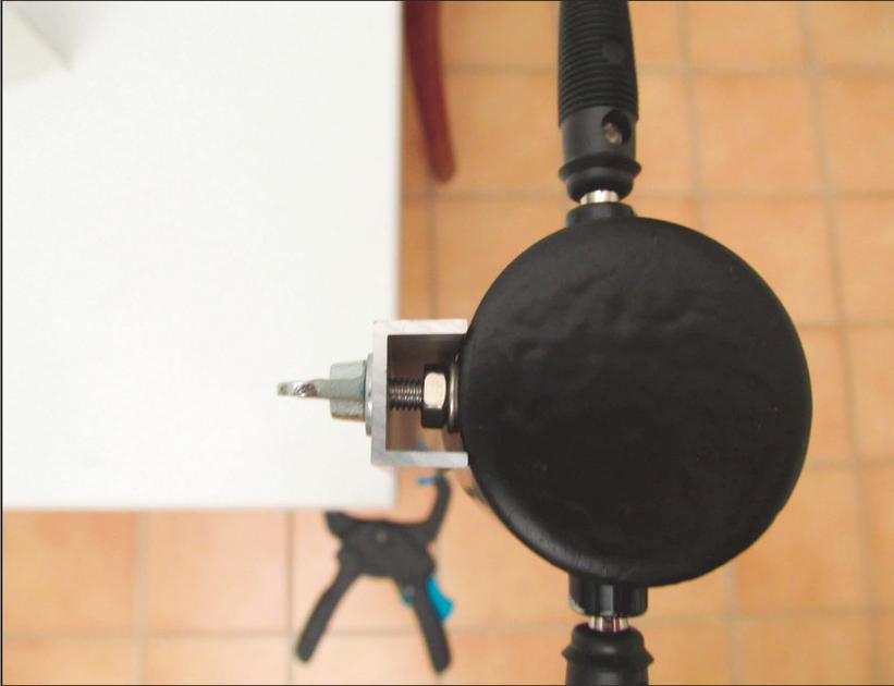
**Abbildung 32.35** Mittelteil, an einem U-Profil befestigt
