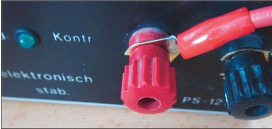
**Abbildung 32.1** Verbindung mit Gabelkabelschuhen
