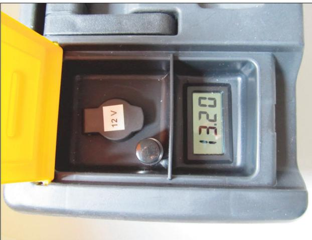
Abbildung 32.7 Steckdose und schaltbares Voltmeter
