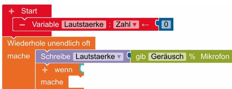
Die LED Bar verfügt über zehn LEDs, die von 0 bis 9 durchnummieriert sind. Wir können die Lautstärke demnach auf zehn verschiedenen Stufen anzeigen. Da jedoch die LED mit der Nummer 0 rot leuchtet, die LED Nummer 1 gelb und die restlichen (2–9) grün, müssen wir mit der neunten und letzten LED anfangen.
