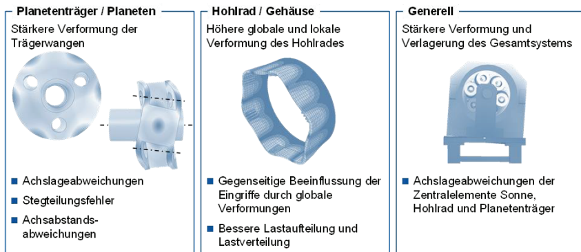
Bild 1: Einfluss hoher Leistungsdichten auf das Verformungsverhalten von Planetengetrieben
