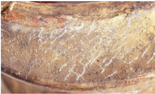
/ 7 / Detail einer Kreuzblume vom Dachfirst , weiße DDT-Kristallablagerungen auf dem Craquelé
