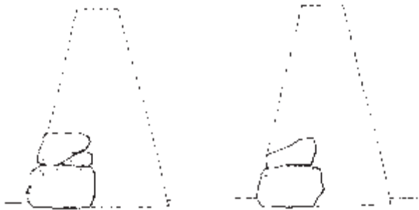
Richtig. Das obere Lager des Steins ist waagrecht, der unterlegte Keil bringt ihn in die gewünschte Position.
