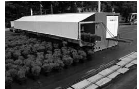
Abb. 429: Ausstellen mit dem GPS-gesteuerten Roboter Terra Spacer von Degamec. Foto: Beltz jun.
