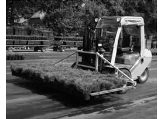
Abb. 428: Transport von Gehölzen in Töpfen mit einer Gabel. Foto: Beltz jun.
