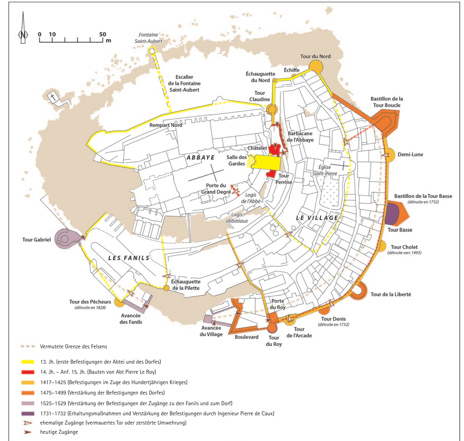
Abb. 2 Bauphasenplan der Befestigungen des Mont-Saint-Michel.
