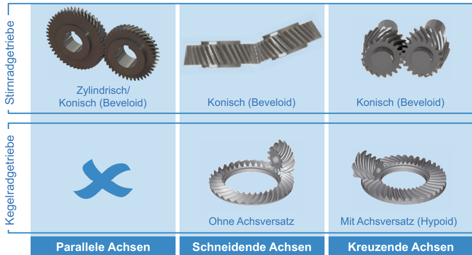
Bild 2.1 Grundformen von Zahnradgetrieben
