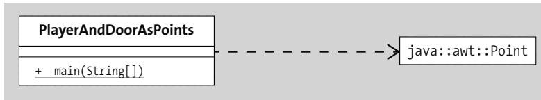
Abbildung 3.4 Die Abhängigkeit zwischen einer Klasse und dem »java.awt.Point« zeigt das UML-Diagramm mit einer gestrichelten Linie an. Attribute und Operationen von »Point« sind nicht dargestellt.
