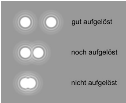
Abb. 1.3 Bildpunkte als Airy-Scheibchen. Die Punkte können noch getrennt beobachtet werden, wenn das zentrale Intensitätsmaximum des einen in das erste Beugungsminimum des anderen fällt.
