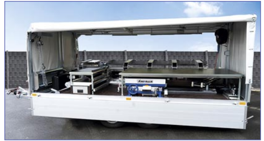
Bild 1: Mobile Spenglerei als Anhänger mit Ausklappdach
