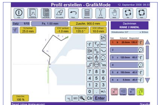
Bild 3: Display einer CNC-gesteuerten Kantbank
