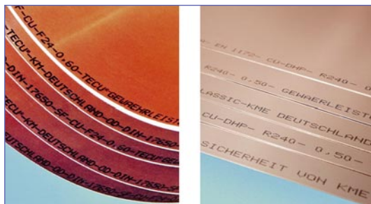
Bild 3: Normgerecht gekennzeichnete Bleche
