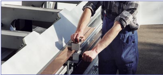
Bild 1: Längsschneidrollenschere für Blech, das in die 3,5 m lange Kantbank eingespannt ist
