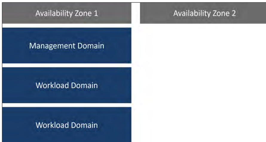
Bild 2: Selbst wenn erst eine Availability Zone existiert oder aufgebaut wird, sollte deren Design idealerweise eine künftige zweite berücksichtigen, etwa zur Erweiterung des Managementnetzwerks.
