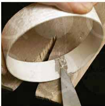
Mit einer Halbrundfeile (Hieb 2) wird hier eine Lötfläche im Innern eines Armreifis gesäubert.
