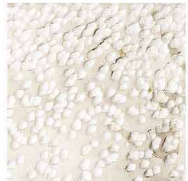
Mit dem Kugelende eines Polierhammers erzeugte Textur. Der obere Teil wurde dicht gehämmert, der untere etwas lockerer.
