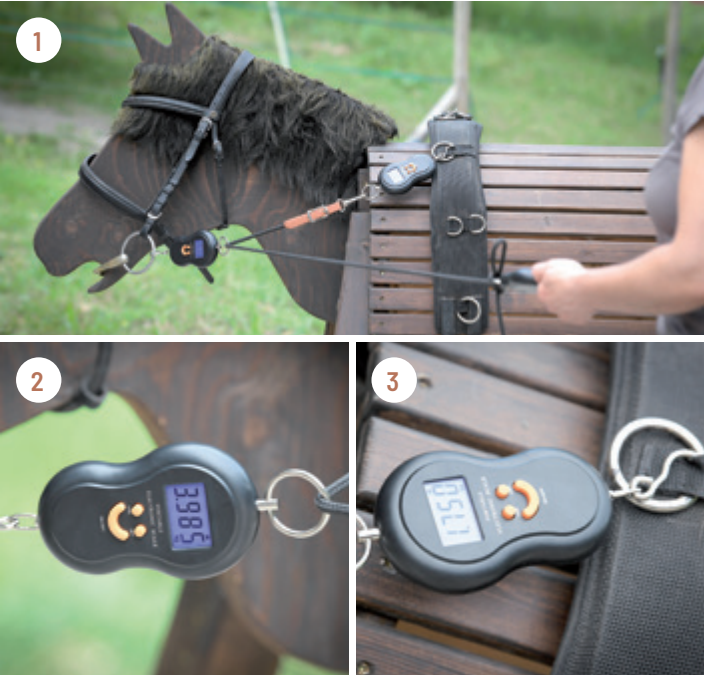
Messungen V-Verschnallung Bild 1: Komplettansicht Bild 2: Kraft am Maul Bild 3: Kraft am Longiergurt Bild 4: Zugkraft an der Hand des Longenführers
