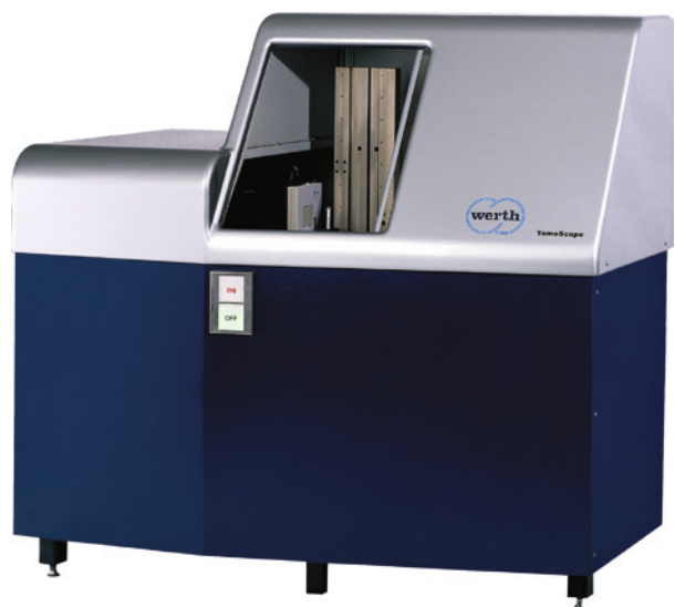
Bild 9.2 Werth TomoScope®: Das erste Koordinatenmessgerät mit Röntgen-Computertomografie und optionaler Multisensorik
