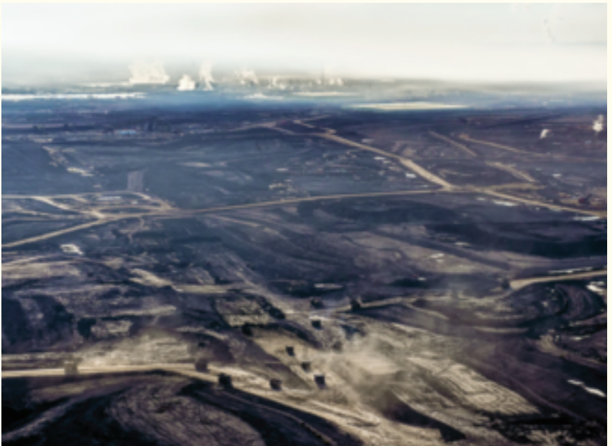
Syncrude-Abbau und -aufbereitung mit »Haulern« im Vordergrund. Die blassen Rechtecke oben rechts sind Schwefellager.
