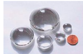
Abb. 5.2: Precision Gobs; Halbzuge für asphärische Blankpresslinge /Hart04/
