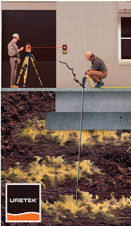
Abb. 197: Baugrundsetzungen können auch durch Injektionen, im Sinne einer Baugrundhebung, saniert werden.
