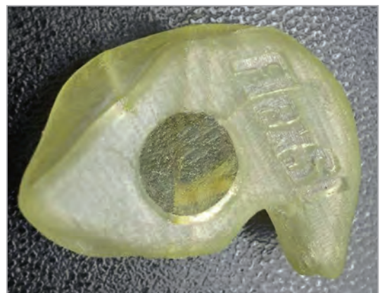
Bild 3: Im Stereolithographieverfahren hergestelltes Gehörkapsel
