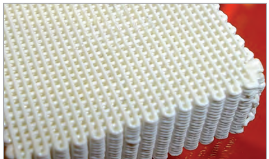
Bild 3: Scaffold, Stützwerk für Knochensubstanz in der regenerativen Medizin
