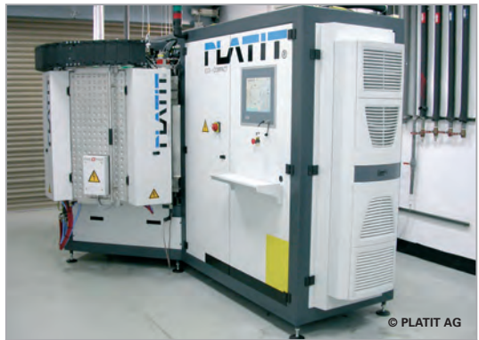
Bild 2: PVD-Beschichten mit Sputter-Anlage
