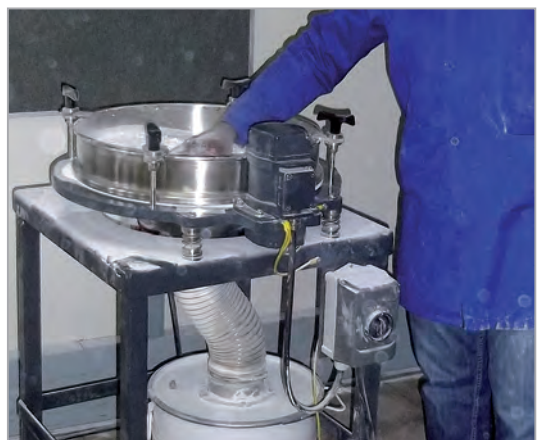
Bild 3: Kunststoffpulveraufbereitung in Siebstation
