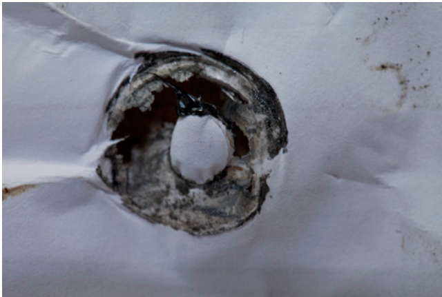
BILD 5.19 Beispiel eines Düsenabdruckes
