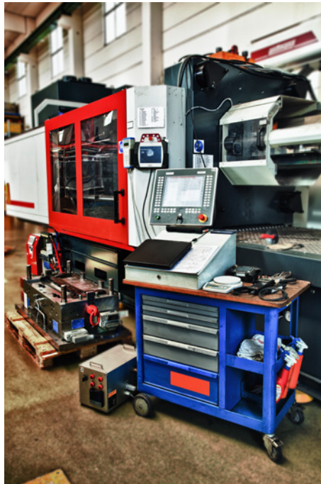
BILD 2.4 Beispiel einer Mustervorbereitung an der Spritzgießmaschine
