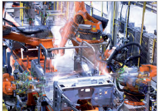
Bild 2: Roboter in der Serienmontage von Auto-karosserien
