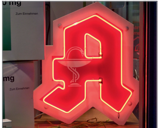
Bild 1: Leuchtröhrenanlage für Spannung bis AC 1000 V
